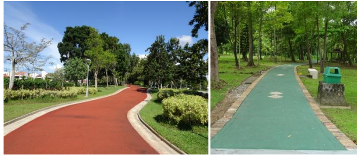
Gambar 48: Kemudahan laluan jogging trek menggunakan EPDM bagi keselesaan semasa berjogging. Sumber: http://www.pinsdaddy.com
